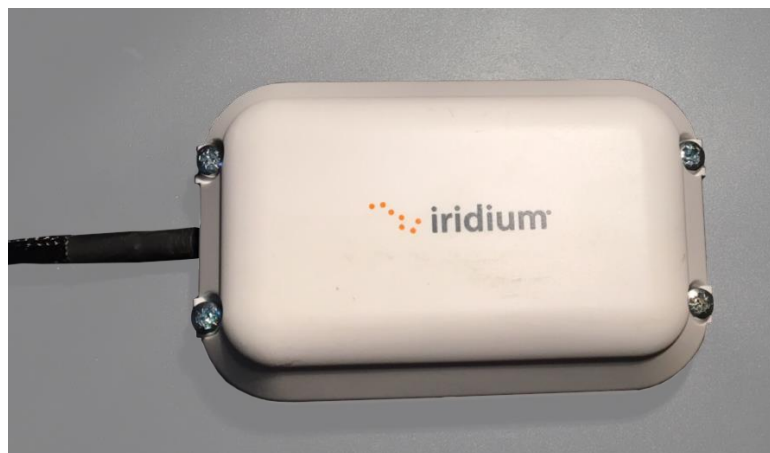
Рисунок 5-3 Установка винтового крепления
