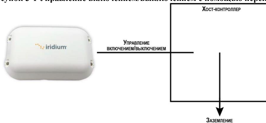
Рисунок 3-1 Управление включением/выключением с помощью переключателя на землю
