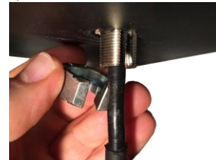
Рисунок 5-6 Установка гайки с прорезью
