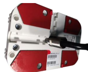
Рисунок 5-4 Установка резьбовой втулки.
